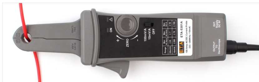
图2: 连接到ETA5301A电流测试钳
